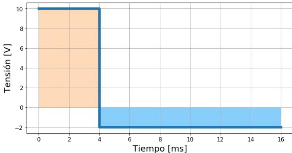
$$V_{DC} = \frac{10\text{V} \cdot 4\text{ms}}{16\text{ms}} - \frac{2\text{V} \cdot 12\text{ms}}{16\text{ms}}$$
