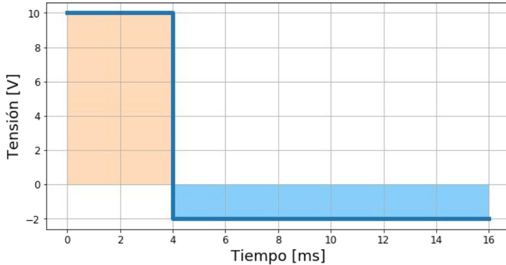
$$V_{DC} = \frac{1}{16\text{ms}} (10\text{V} \cdot 4\text{ms} - 2\text{V} \cdot 12\text{ms})$$
